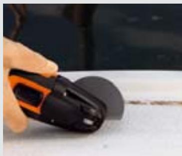
Разрезные работы на корпусах судна из стеклопластика или армированного углеволокном пластика рекомендуется производить сегментными пильными полотнами с твердосплавным напылением. Пользователя порадует абсолютная чистота разреза (ширина 0,5 мм) без разрыва и прочих повреждений ламината.
