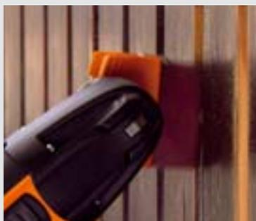
Сменными профильными вставками этого комплекта для шлифовки профилей можно шлифовать узкие места, пазы и профили без малейших затруднений и со значительно повышенным съемом материала.
