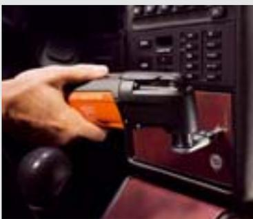
MiniCut и комплект шлифовальных вставок позволяют без труда выполнять разрезы размером до 10 мм, в том числе в труднодоступных местах. Возможна работа по пластику, металлу и дереву.
