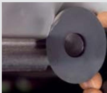
Для локального ремонта автомобиля, поврежденного в результате дорожного происшествия, особенно подходят сегментные пильные полотна из быстрорежущей стали. Их можно многократно устанавливать на приводной вал, что значительно повышает срок службы. Номер заказа
