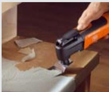
Остатки клея для коврового покрытия, покрытие или другие затвердевшие материалы не имеют ни малейшего шанса устоять перед твердым шпателем.
