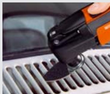
Узкие места или расположенные глубоко области можно оптимально обрабатывать наконечником пальцевой формы.
