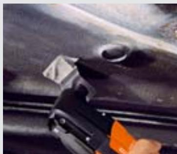
Твердый шпатель максимально быстро снимает антикоррозийное покрытие и другие затвердевшие материалы.
