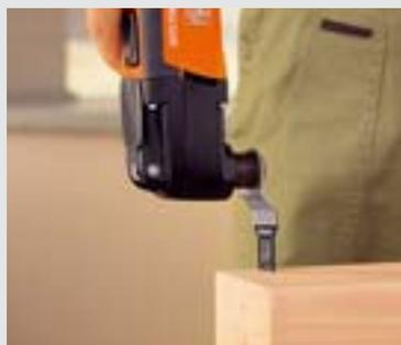
Универсальные пильные полотна E-Cut обеспечивают рез глубиной до 60 мм.
