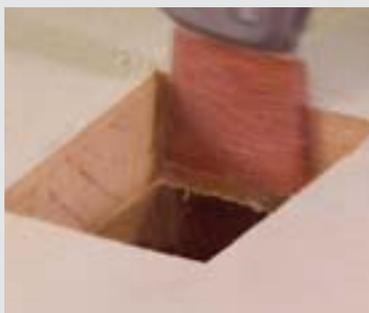
MiniCut и комплект шлифовальных вставок позволяют затачивать отверстия с нужной точностью.
