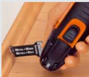
Возможно выпиливание установленных нижних планок на стенах и полу без риска повреждения, что позволяет избежать последующей работы, которая раньше отнимала много времени.
