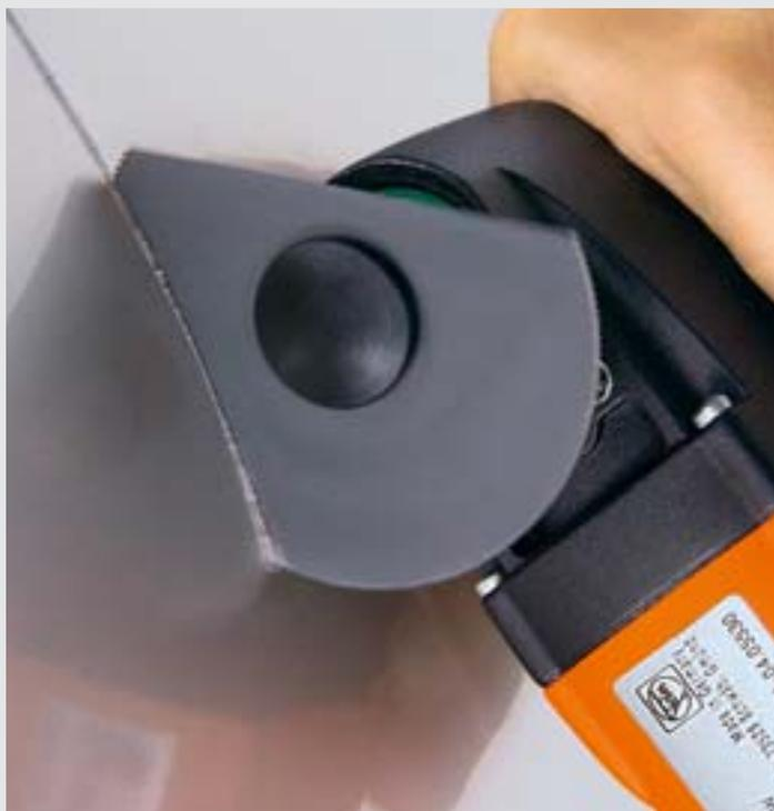
Жесть и пластик толщиной до 1 мм разрезаются сегментными пильными полотнами без заусенцев и ухода в сторону при минимальном разлете искр без дорогостоящей последующей обработки. Возможно применение в различных углах.
