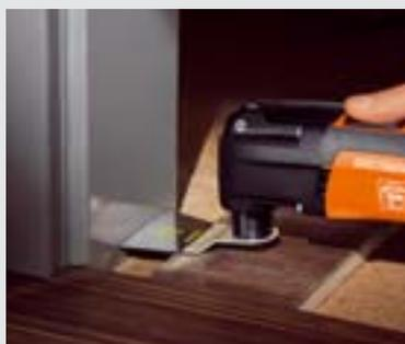
При подгонке дверных рам в соответствии с более высоким напольным покрытием, а также пазы в паркете и ламинате пильные полотна E-Cut гарантируют прекрасную точность и скорость.
