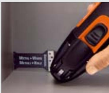
Пильные полотна E-Cut позволяют без дорогостоящего демонтажа вырезать отверстия в стенах шкафов и стеллажей для доступа к кабелю, розеткам и подводкам воды.
