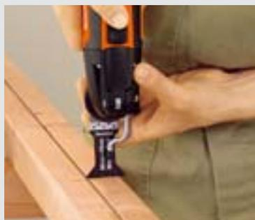
Ограничитель глубины позволяет плавно регулировать глубину резания всех полотен E-Cut и пильных полотен по дереву из быстрорежущей стали.
