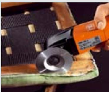
Сегментное пильное полотно с твердосплавным напылением поможет сберечь силы и не повредить мягкую мебель — скобы снимаются с легкостью без использования клещей.
