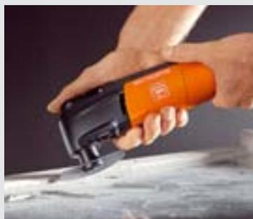
Растрескавшуюся замазку можно без труда удалить сегментным пильным полотном с твердосплавным напылением без риска разбить стекло.
