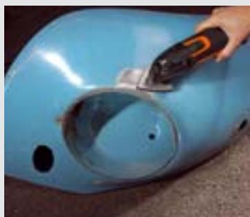
Неудачная лакировка, проплешины и необработанные участки, которые раньше приходилось исправлять вручную, не представляют трудностей для FEIN MULTIMASTER: высокий съем материала и равномерная шлифовка гарантируются. Принадлежности см. в разделе «Шлифовка» на стр. 19.
