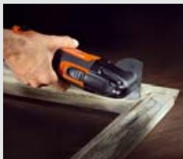
Сегментное пильное полотно из быстрорежущей стали позволит вернуть изначальный вид любым, даже очень старым окнам; без малейшего труда пользователь сможет обработать углы, сэкономив время на последующей доработке.
