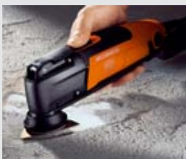
Используя твердосплавный рашпиль для шлифовки штукатурки, цемента, бетона или плиточного клея, можно избежать долгой и дорогостоящей ручной работы.
