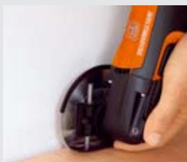
Благодаря пильному полотну по дереву из быстрорежущей стали FEIN MultiMaster является отличной дисковой мини-пилой, идеально подходящей для длинных и точных разрезов, например эластичных швов в паркете и ламинате. Для работы с ограничителем глубины или без него.
