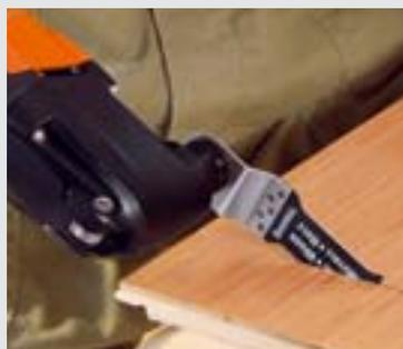
Универсальное пильное полотно E-Cut разрежет паркет, ламинат или композиционные материалы с высокой точностью без риска повреждения.
