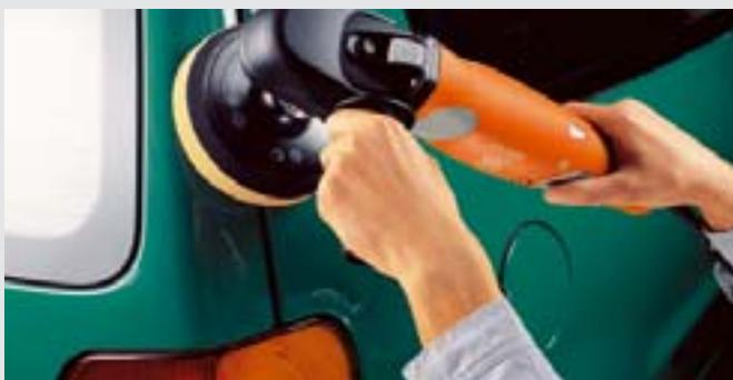
Ручная полировальная машинка FEIN WPO 13-15 E работает даже при длительной эксплуатации без перегрева. Головка редуктора остается охлажденной. Поэтому нет необходимости в частом обременительном выключении машинки при перегрузке. А это позволяет сэкономить рабочее время и затраты. И колебания числа оборотов при нагрузке – это тоже проблема прошлого.
