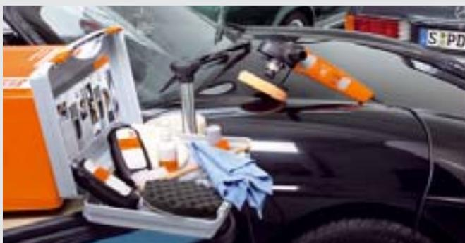
Результат полирования машинкой во многом зависит от того полировочного средства, которое Вы используете. А самое лучшее полировочное средство без первоклассного полировального оборудования не принесет большого результата. В набор для полирования фирмы FEIN входит и то и другое: Машинка FEIN WPO 13-15 E и полировочные средства с наночастицами. Только так Вы с гарантией добьетесь блестящих результатов, также с точки зрения экономичности.
