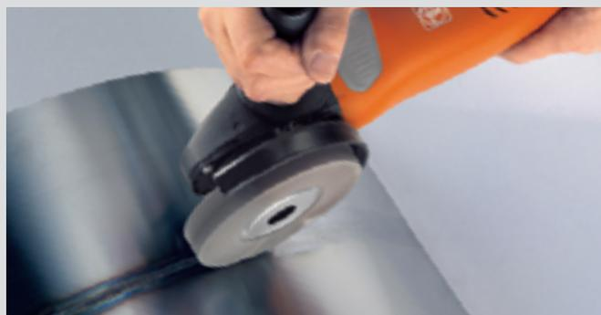
Созданный специально для работ в углублениях, углах и на кромках, пластинчатый шлифовальный круг обеспечивает высокую интенсивность съема материала и возможность работы под сводами или на кромках.
