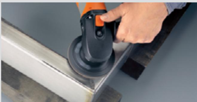
Для сглаживания сварного шва и окружающих поверхностей предназначено шлифовальное полотно FEIN. Оно подходит для работ с нержавеющей сталью и отличается низкими оборотами при полной мощности, обеспечивает точность и хорошие показатели съема материала.
