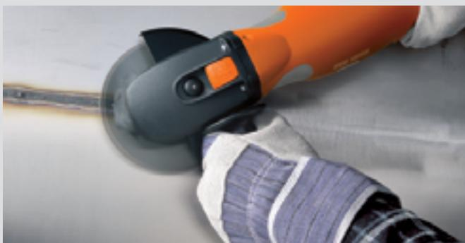
Высокая интенсивность съема материала, хорошая просматриваемость обрабатываемой детали и малый нагрев – решительно все говорит в пользу применения секционного диска. При развитии максимальной мощности число оборотов не превышает 7000 об/мин, и это превосходно согласуется с требованиями для нержавеющей стали и для машины WSG 13-70 E.
