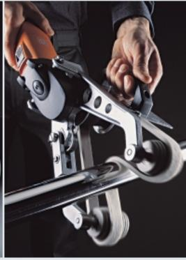
Шлифовка и полировка. Для профессионалов, работающих со специальной сталью.
