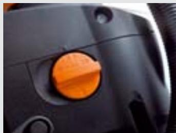
Двухскоростная коробка передач для оптимального числа оборотов для верхнего и нижнего диаметров.
