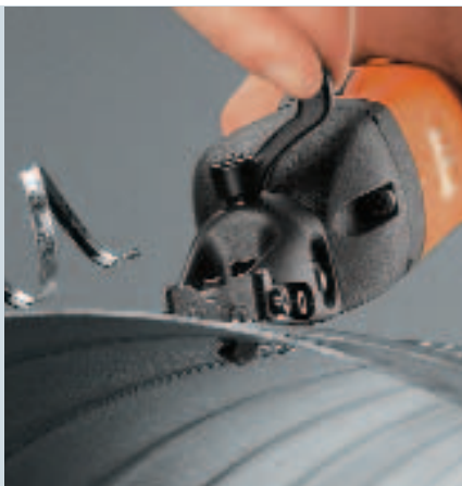
BSS 1.6 C со встроенным стружколомом
