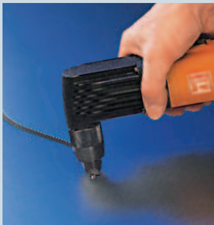
Двигатель HIGH-POWER для жести толщиной до 2 мм
