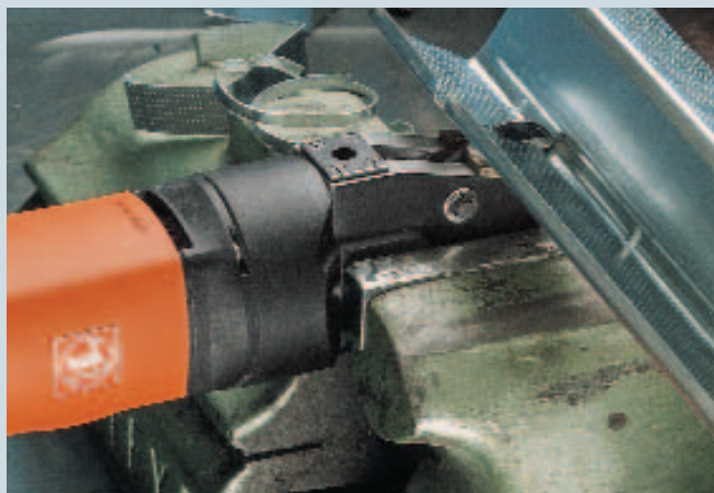
Благодаря особенно прочной режущей головке, инструмент можно использовать стационарно
