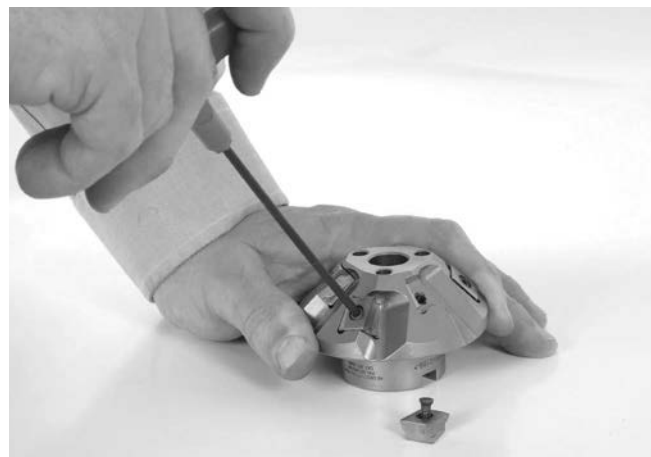
Рис. 18 – Замена вставных резцов
