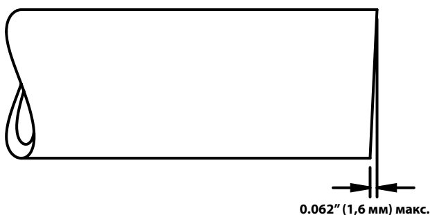
Рис. 6 – Требования прямоты трубы
