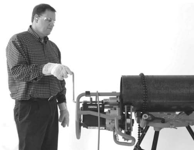
Рис. 15В – Снятие фаски
