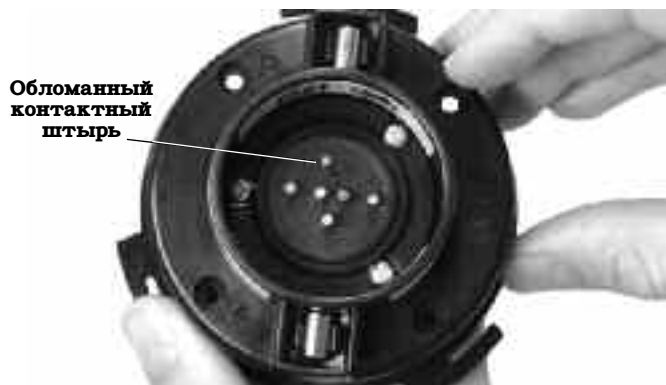
Рис. 12 – Обломанный контактный штырь
