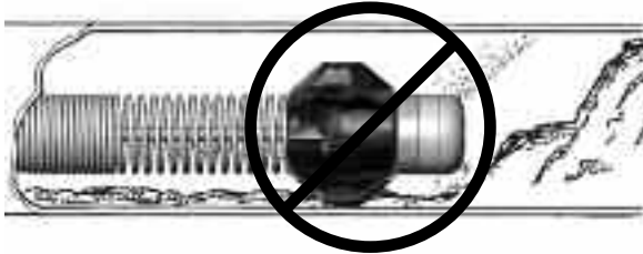
Рис. 22 – Обнаружение засора – Запрещается использовать головку видеокамеры для прочистки засоров
