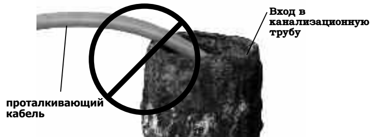
Рис. 23 – Не следует вытягивать кабель по острым кромкам
