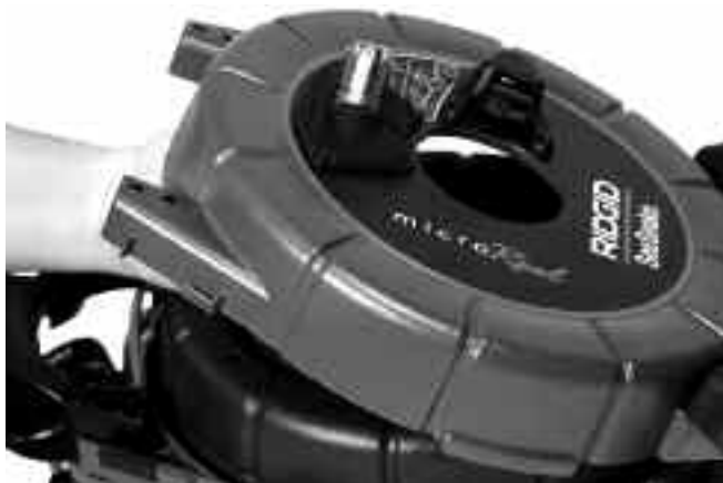
Рис. 5 – Осторожно откройте барабан, чтобы уложить кабель
