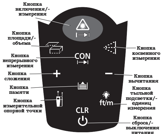
Рисунок 2 – Кнопки прибора micro LM-100
