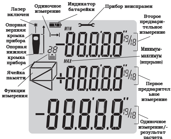
Рисунок 3 – ЖК дисплей прибора micro LM-100
