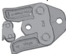
Пресс-пистолет представляет собой электрогидравлическое устройство. Электромотор приводит в действие гидравлический насос. Давление гидравлической жидкости передается приводному поршню (с одной стороны). К штоку этого поршня подключены пресс-ролики (5). Сила отводится с помощью кулачков пресс-клевшей (7), в результате пресс-ролики создают давление обжатия.
